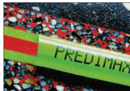
Predimax® mit CEMproof® Crack-Seal verpresst.
